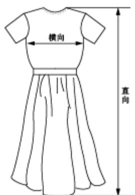
图 6 连衣裙水洗前后测量部位示例
